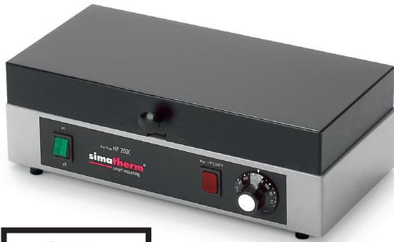
Die beiden elektrischen Anwärmpfatten mit thermostatgesteuerter Erwärmung eignen sich speziell für kleine Lager und Maschinenteile. Die Temperatur lässt sich am Regler stufenlos zwischen 50°C und 200°C einstellen.
