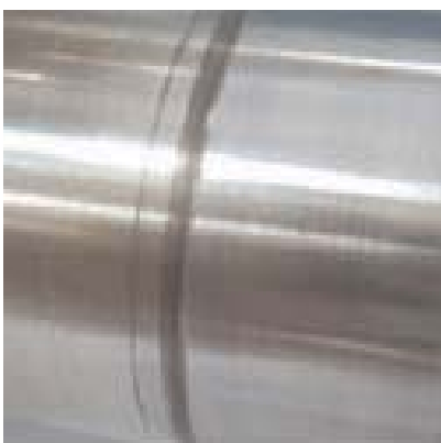
Verschlossene Welle mit Einlaufspur
