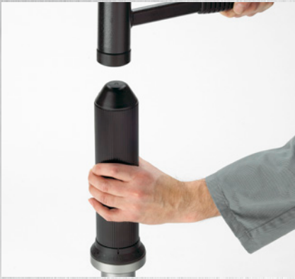
Korrekte Werkzeughandhabung zum Wälzlager-Einbau.
