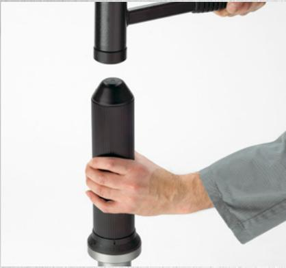
Korrekte Werkzeughandhabung zum Wälzlagereinbau.
