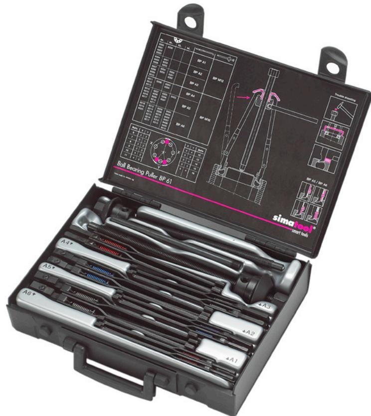
Der Ausbauwerkzeugsatz BP 61 ermöglicht Rillenkugellager von der Welle abzuziehen oder aus dem Gehäuse herauszuziehen. Auch abgedichtete Lager können nach Entfernen der entsprechenden Dichtung ausgebaut werden. Die Finger der Abzieharme werden an der Aussenringlaufbahn ange-setzt. Er ist für den Ausbau von 61 verschiedenen Rillenkugellagern mit Bohrungsdurchmesser von 10 bis 100 mm geeignet.
