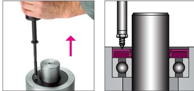
Die Schneidschraube in die Dichtung schlagen und eindrehen. Die Dichtung durch Schlagen mit dem Gleithammer in die Gegenrichtung entfernen.
