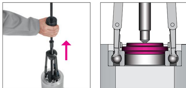
Die Stützscheibe ersetzt die Welle am Innenring und wird mit der Gewindespindel verspannt. Das Lager durch Schlagen mit dem Gleithammer ausziehen.
