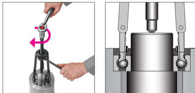
Abzieharme im Lager zwischen den Kugeln platzieren. Mit der Gewindespindel das Lager von der Welle abziehen.
