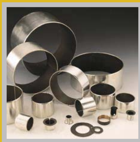
GEROLLTES VERBUNDGLEITLAGER, STAHL/PTFE, WARTUNGSFREI
