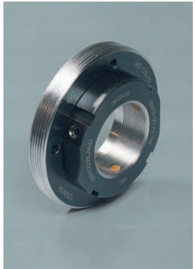
Bild 7.12: Kompakte Kombination von Präzisions-Dichtring-Spannmutter MD mit Außengewinde zur Festlegung der Lageraußenringe und Präzisions-Labyrinth-Nutmutter MMRS zum Vorspannen der Innenringe und zur gleichzeitigen selbsthaltenden Abdichtung
