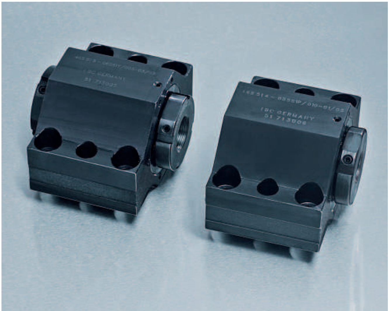
Bild 5.23: Montagefreundliche IBC Präzisions-Sonder-Stehlagereinheiten mit abgesetzter Auflagehöhe und definierter Anlagekante zum Recken eines langen KGT
