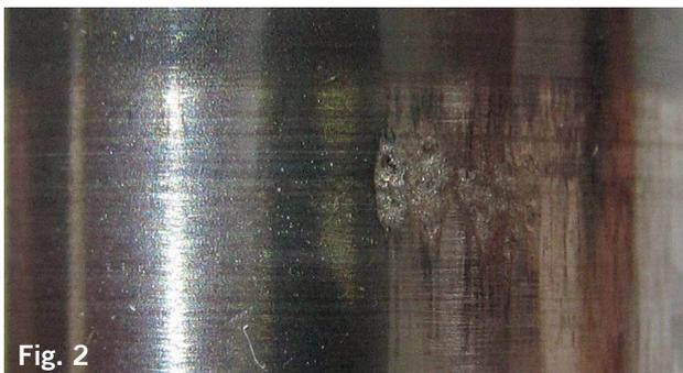
Stromüberschläge haben auf der abgebildeten Innenringlaufbahn (Abb. 1) und der Mantelfläche des Wälzkörpers (Abb. 2) eines Zylinderrollenlagers zur Kraterbildung geführt.
