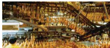
Fleischverarbeitung: Verpackungslineie, Hängeförderer, Wagenausrüstung
