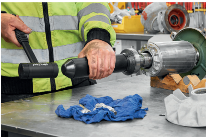
Mit dem Fitting Tool FT 33 werden bei der Montage die Kräfte gleichmässig auf das neue Lager übertragen.
