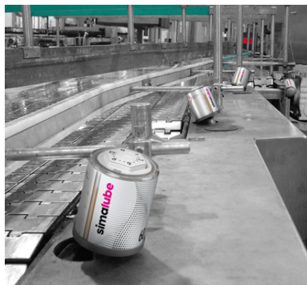
Eine Abfüllstrasse ist ausgerüstet mit mehreren simalube Schmierstoffspendern.
