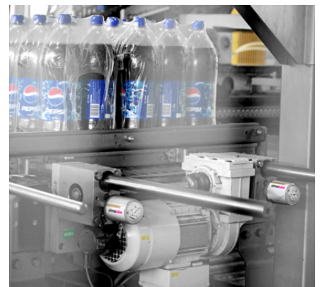
Die Lager am Getriebe sind mit zwei 60 ml simalube Spendern geschmiert.
