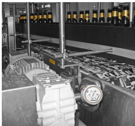
Schmierung des Transportbandes mit einem simalube Spender.
