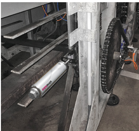
Kettenschmierung mit einem simalube 250 ml und einer Flachbürste.
