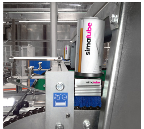
Die beiden simalube mit Bürste schmiern die Kette in einer Brauerei.
