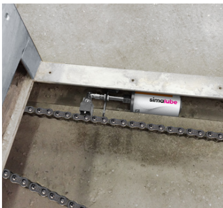
Erfordern es die Platzverhältnisse, kann der simalube auch schräg installiert werden.
