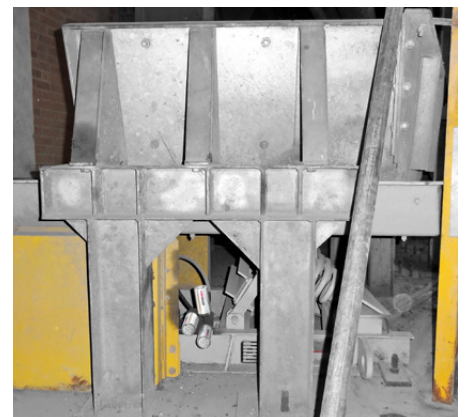
Mehrere 125 ml simalube Schmierstoffspender schmieren den Vibrationsförderer.
