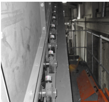
Dutzende 30ml simalube Schmierstoffspender versorgen die Wälzlager eines Förderbandes mit dem nötigen Schmierstoff.
