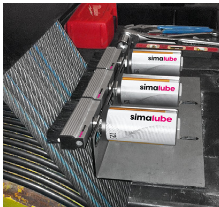
Drei simalube Spender 125 ml inkl. Bürsten-Applikation schmieren und reinigen gleichzeitig die Seile.
