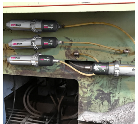
Dank dem Druckverstärker simalube IMPULSE kann man die Schmierstellen am Spuler (Lagerung, Führungsbüchse und Verzahnung) abgesetzt montieren und über eine Schlauchinstallation mit Schmierstoff versorgen.
