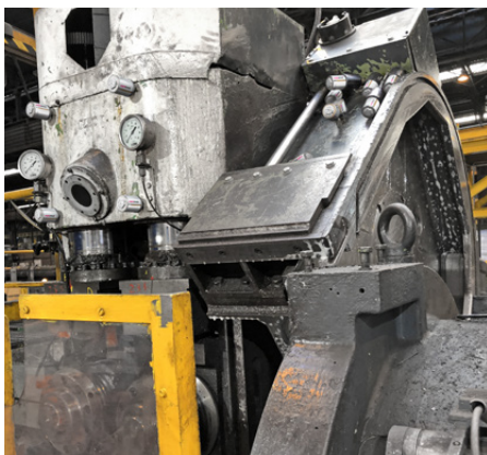
Mehrere simalube Schmierstoffgeber und IMPULSE schmieren die Säulen (links) sowie den Antrieb (rechts) der Nibbelmaschine.
