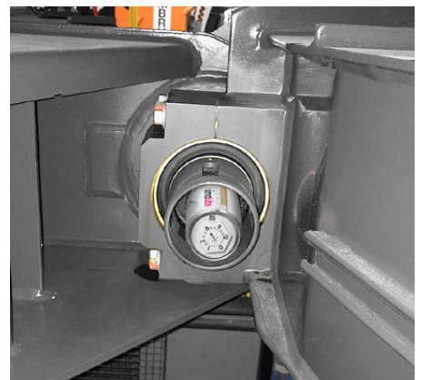
Die Kupplung zweier Eisenbahnwagen ist mit einem simalube 125 ml geschmiert.
